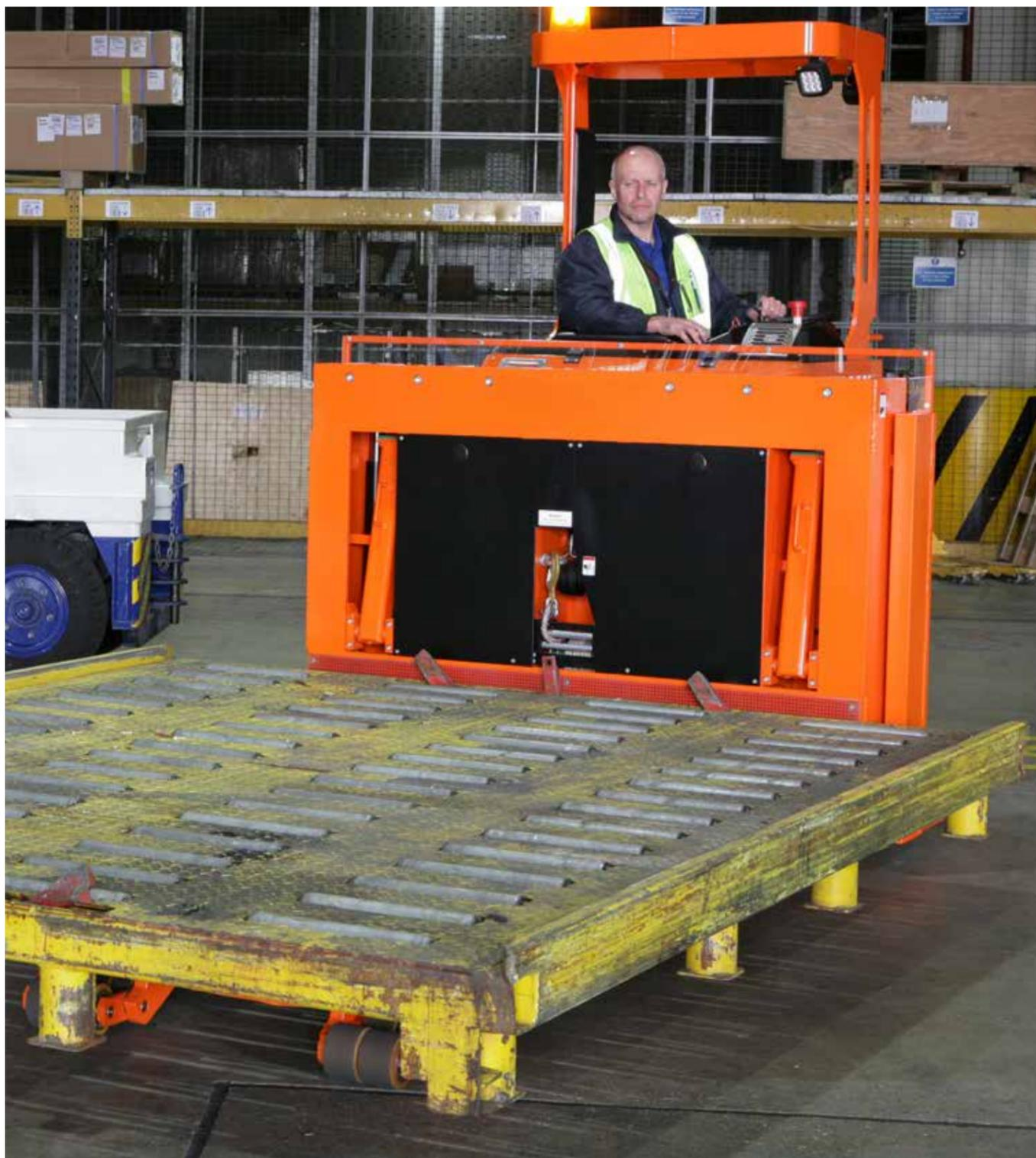
Der DONKEY transportiert ULD's auf allen gängigen Slave-Paletten Typen sicher und schnell und deckt so den kompletten Bereich des Innentransportes von Luftfrachtpaletten ab.
